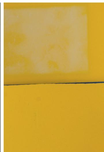
UV-Stabilität im Vergleich. Polyurea-Gelcoat (unten) und konventioneller UP-Gelcoat (oben). Der neue Gelcoat zeigt nahezu keine optische Veränderung nach 500 Stunden UV-B Belastung.
