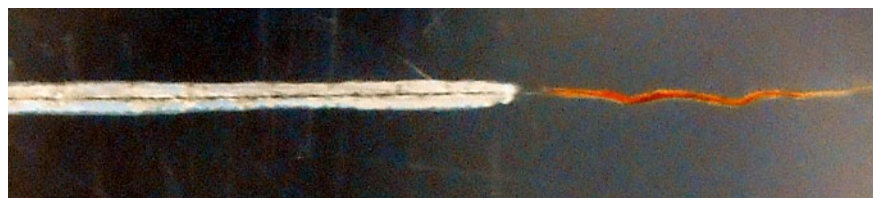
Ergebnis der Salznebelprüfung nach 168 Stunden: Unterwanderung 2 mm
