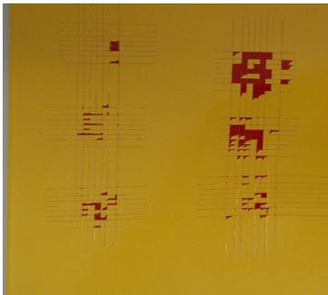
**Abb. 4: Poor adhesion**
