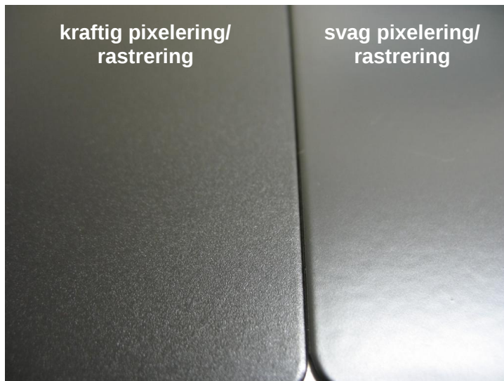
bild. 3: Skillnader i pixelering/rastrering mellan olika dryblend pulverlackar
