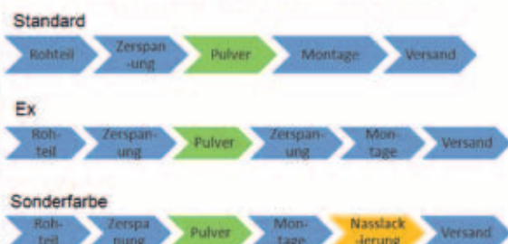
Bild 2: Veränderte Wertschöpfung durch die Einzelteil-Pulverbeschichtung
