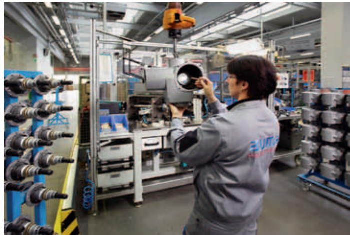
Bild 7: Komplettproduktmontage mit gepulverten Einzelteilen und Baugruppen
