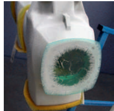
Bild 6: Maskierung während den Versuchsreihen. Partien, die nicht beschichtet werden dürften, wurden mit hitzebeständigen Klebefolien abgedeckt.
