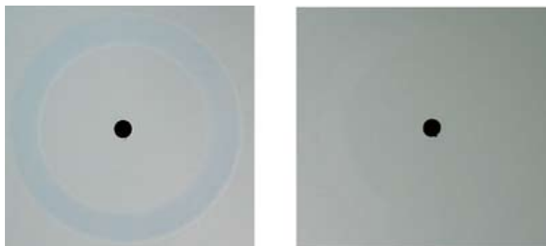
Bild 2: Signifikanter Unterschied nach 300 Belastungszyklen – der Standard Pulverlack links gegen den hochabriebfesten Pulverlack auf der rechten Seite
