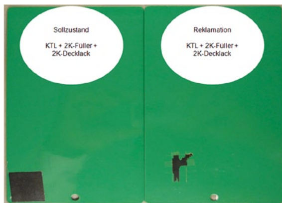
Bild 4: Haftungsverlust durch nicht ausreichende Vernetzung
