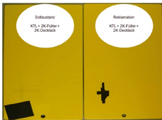
Bild 5: Haftungsverlust durch nicht ausreichende Vernetzung. Im Vergleich zu Bild 4 ist hier eine größere Unterwanderung und eine Enthftung zur Grundierung zu erkennen und auch keine ausreichende Vernetzung gegeben.
