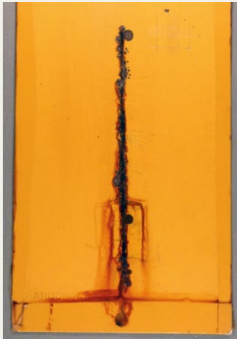
Bild 1: Entfettetes und grundiertes Stahlblech nach 240 h Salzsprühnebelprüfung
