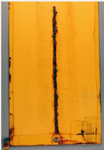
Bild 2: Eisenphosphatiertes und grundiertes Stahlblech nach 240 h Salzsprühnebelprüfung
