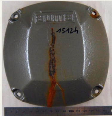
Salzsprühnebelprüfung Grauguss (zinkphosphatiert) nach 1512 h
