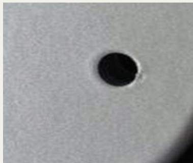
Druckgussteil, beschichtet mit entgasendem Pulverlack in kritischem Metallic-Farbtönen
