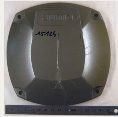
Salzsprühnebelprüfung Druckguss (zinkphosphatiert) nach 1512 h
