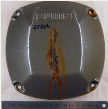
Salzsprühnebelprüfung Grauguss (zinkphosphatiert) nach 2520 h
