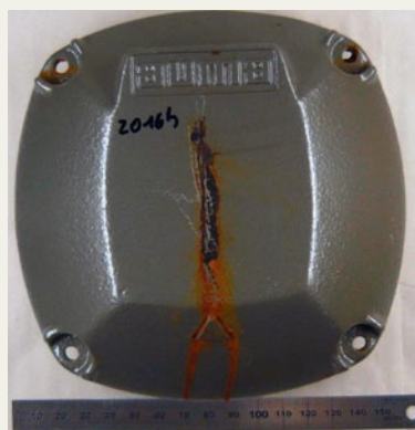
Salzsprühnebelprüfung Grauguss (zinkphosphatiert) nach 2016 h
