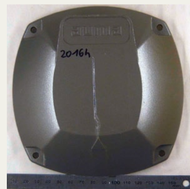
Salzsprühnebelprüfung Druckguss (zinkphosphatiert) nach 2016 h
