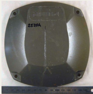
Salzsprühnebelprüfung Druckguss (zinkphosphatiert) nach 2520 h
