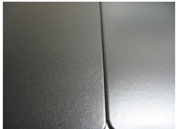
Bild 2: Der Sparkling-Effekt ist bei den neuen Dry-Blend-Pulverlacken (rechts) im Vergleich zu Standard-Systemen (links) stark reduziert
