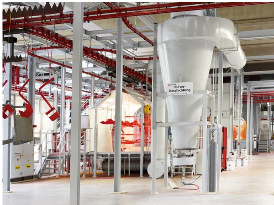
Mit der neuen Beschichtungsanlage am Standort Korbach sollte eine einheitliche Beschichtung sowie eine energieeffiziente Pulverlackierung erzielt werden. Die neu eingesetzten Pulverlacke bieten Standard-Polyesterqualität für den Außeneinsatz bei einer zusätzlichen Produktivitätserhöhung der Lackieranlage.
