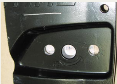
Die Ergebnisse des Salzsprüh- und Schwitzwassertests sind hervorragend. 1000 Stunden übersteht das Magnesium-Bauteil mit der neuentwickelten ATL-Automotive-Qualität ohne Probleme.
