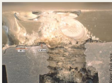
In Bezug auf die Kontaktkorrosion liefert die ATL (linkes Bild) keine schlechteren Ergebnisse als die KTL-Beschichtung (rechtes Bild)
