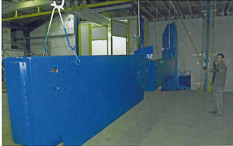
Wenngleich der Aushärteprozess schwerer Maschinenbauteile, wie hier bei Meeh Jumbo-Coat, viel Energie benötigt, bieten Niedertemperaturpulverlacke die Möglichkeit, die Einbrenntemperatur zu reduzieren.
