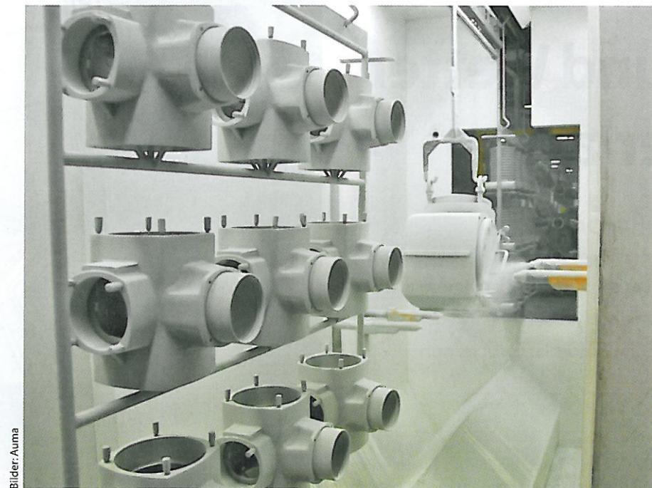
Gegenüber einer Nasslack-Applikation ermöglichen Pulverlacke neben Einsparungen im Bereich der Lackkosten auch reduzierte Durchlaufzeiten.
